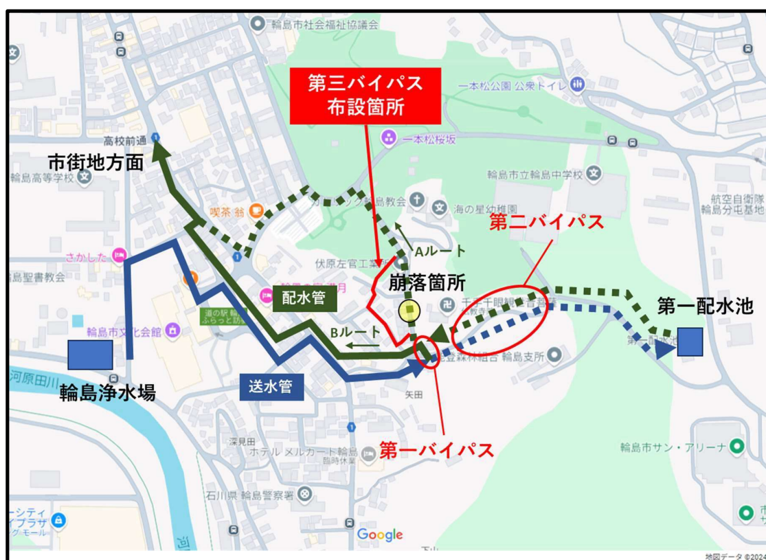
図 3-6 第一配水池からの配管状況
