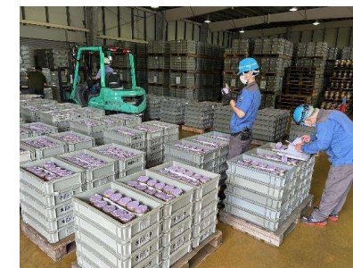
▲水道メータ納品検査
